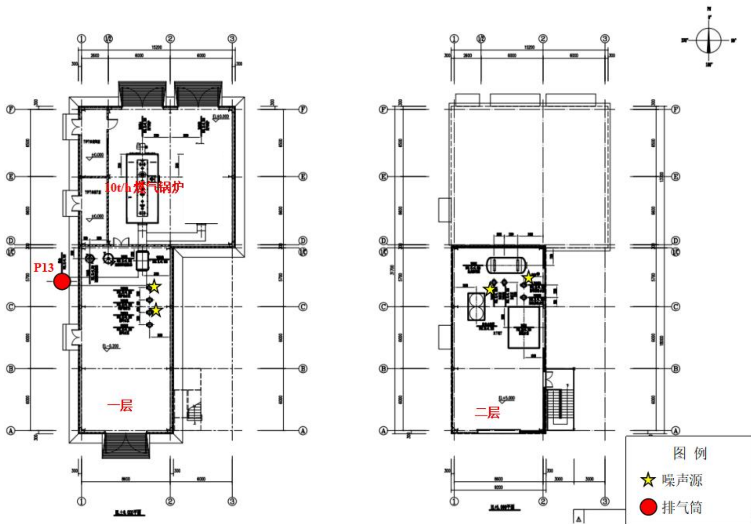
附图 6 锅炉房平面布置及噪声源分布示意图
